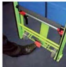
14. Assurez-vous que le mécanisme de frein est verrouillé.
