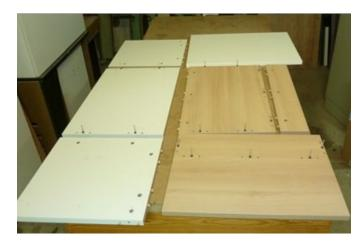
D. Commencez le montage comme sur les photos, attention de mettre les vis de serrages en direction de l'intérieur du caisson. Commencer par monter les panneaux blancs puis ceux de couleur bois.
