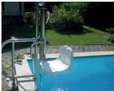
Contrôle de la profondeur d'immersion (palier inférieur) et de la hauteur d'entrée (palier supérieur)
