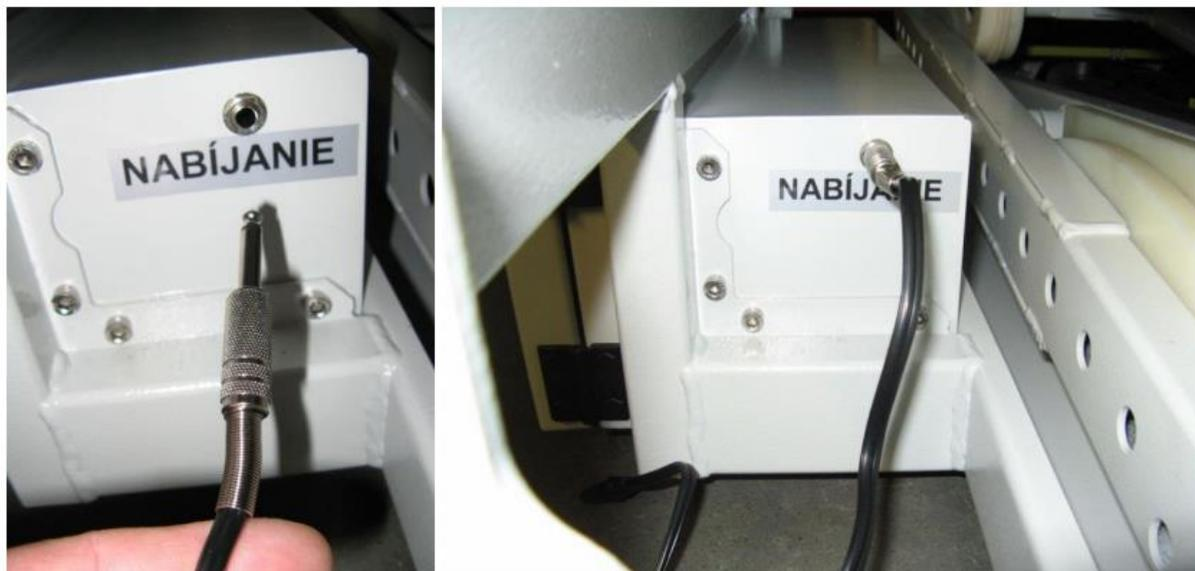
Méthode 2 : Connecter le chargeur à la batterie avec un port auxiliaire. La batterie doit être retirée de la plateforme et le chargement peut donc s'effectuer séparément de la plateforme.
