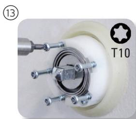
13 Si le vissage s'opère sur les plaques de propreté, exercer une forte pression au moment du premier vissage de chacune des vis. Tout manquement à exercer cette pression pourrait décoller les plaques et les faire venir à soi. Renouveler ce même processus de l'autre côté de la porte.
